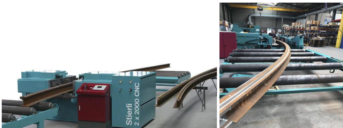
Slika 11. a) 2200NC – Stroj za savijanje i ravnanje (žljebastih i Vignolovih) tračnica, b) tračnice prilikom procesa savijanja [17]
