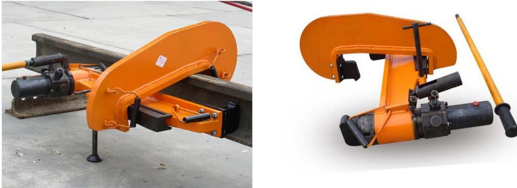
Slika 12. YZG 750 II hidraulički uređaj za savijanje tračnica [19]
