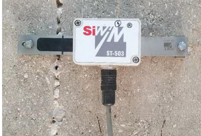
Slika 21. Primjer prijenosnog SiWIM uređaja [9]
