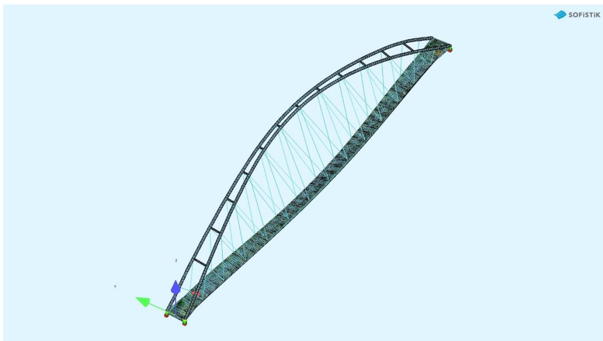
Slika 43. Drugi mod izvijanja; vlastita frekvencija za drugi mod: f = 0,82 Hz, period za drugi mod: T = 1,22 s
