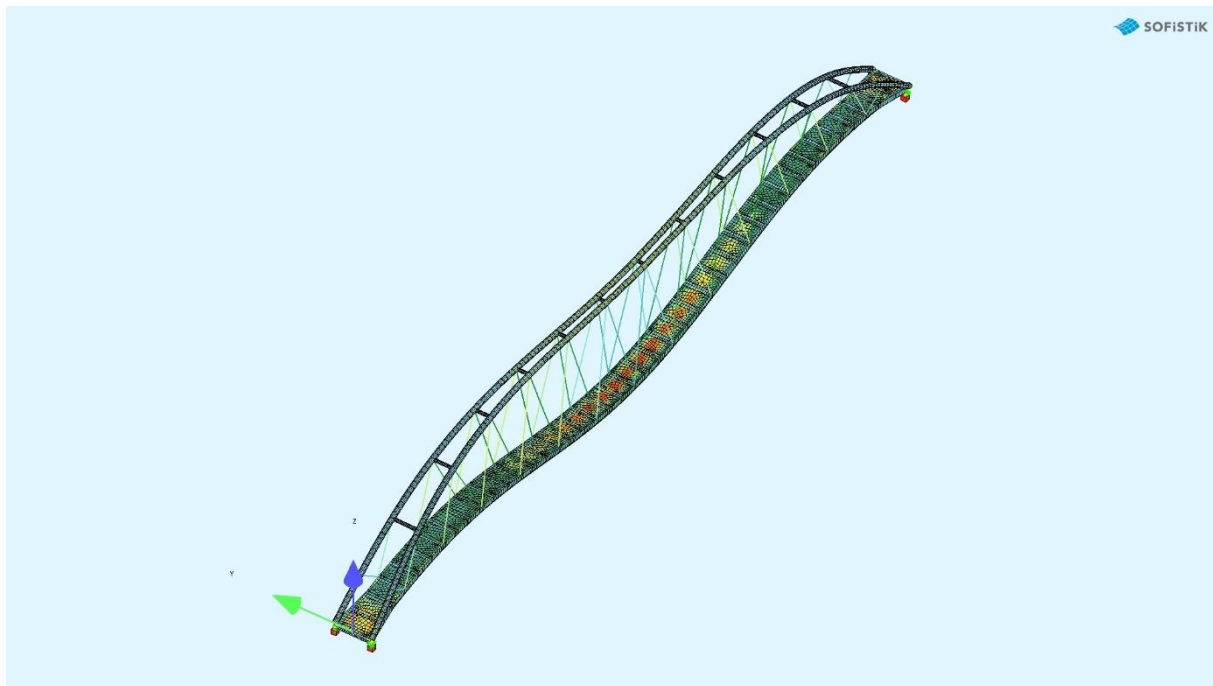
Slika 46. Peti mod izvijanja; vlastita frekvencija za peti mod: f = 1,31 Hz, period za peti mod: T = 0,76 s
