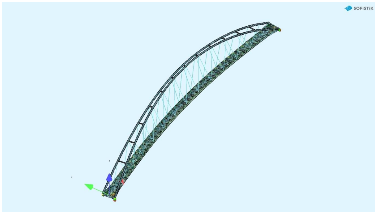
Slika 42. Prvi mod izvijanja; vlastita frekvencija za prvi mod: f = 0,34 Hz, period za prvi mod: T = 2,94 s
