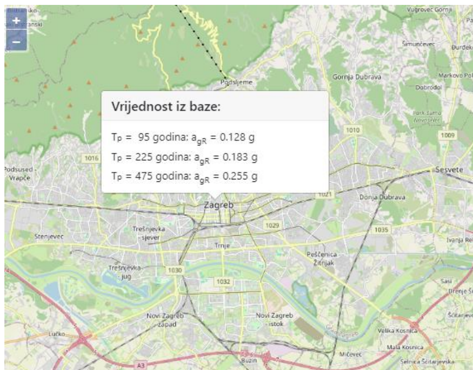
Slika 44. Vršna ubrzanja tla a_{gR} za grad Zagreb [7]
