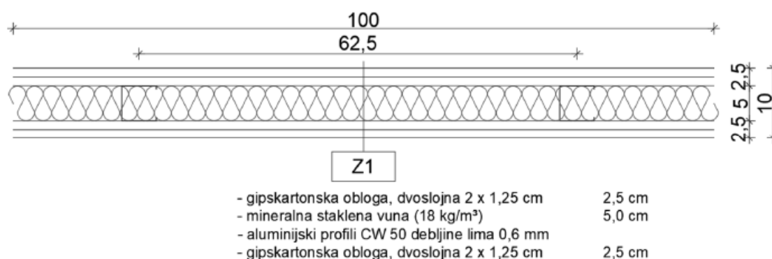
Slika 4.1. Presjek gipskartonskog pregradnog zida
