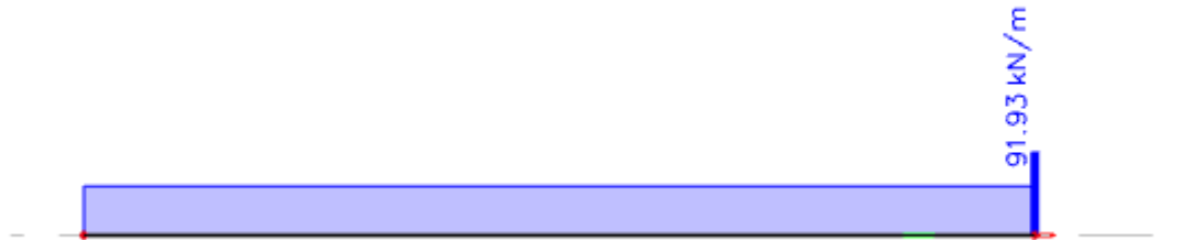
Slika 9.7. Reakcija R_z na osloncu greda – etaža 1
