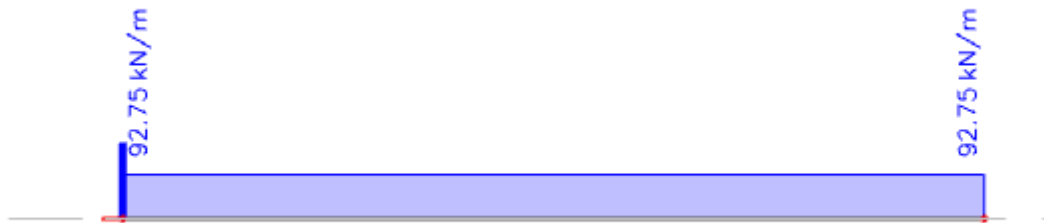
Slika 9.4. Reakcija R_z na osloncu greda – etaža 2
