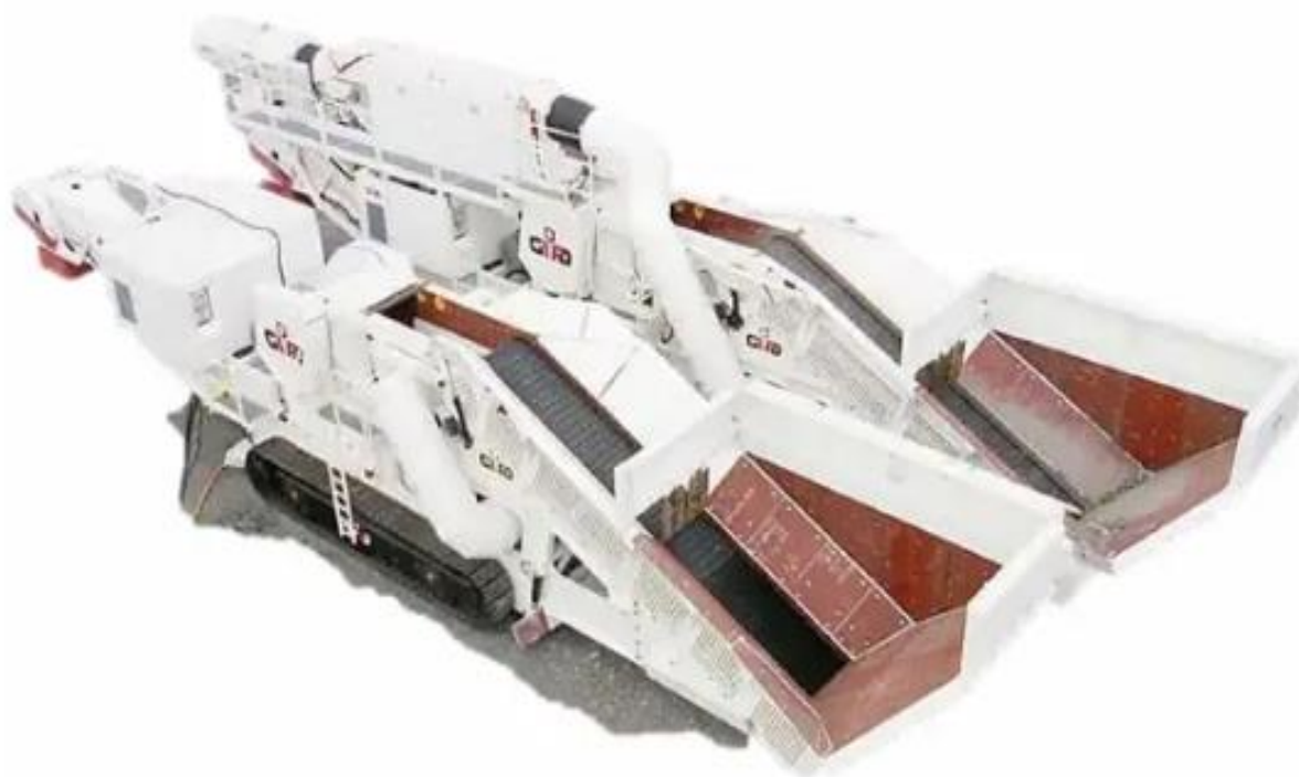
Slika 25- čeljusna drobilica CHRUSER GIPOBAC B1185 PB FDR E [29]
