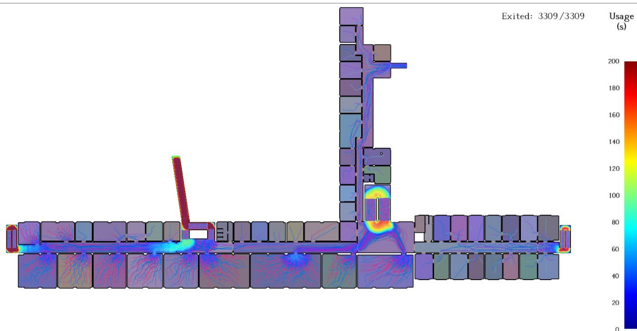
Slika 28 Prikaz ukupnog vremenskog perioda korištenja hodnih površina te trajektorija kretanja prilikom evakuacije za novo stanje – tlocrt 1.kata
