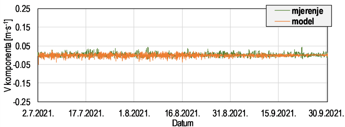
Slika 0-54 Usporedba U (gore) i V (dolje) komponenti brzine strujanja na dubini od -30 [m] za ljetno razdoblje na poziciji ADCP-RI1
