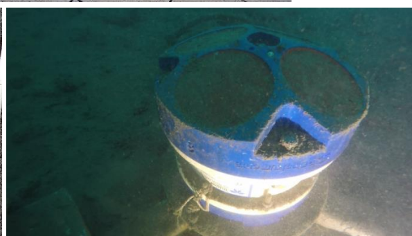
Slika 4-16 Fotografije ADCP mjerača strujanja tipa WorkHorse Sentinel postavljenog na poziciji ADCP-PL1 i Sentinel V20 postavljenog na poziciji ADCP-PL2 u luci Ploče – gore; ADCP mjerača strujanja tipa WorkHorse Monitor prije postavljanja – dolje lijevo i postavljenoga na dnu luke Rijeka – dolje desno
