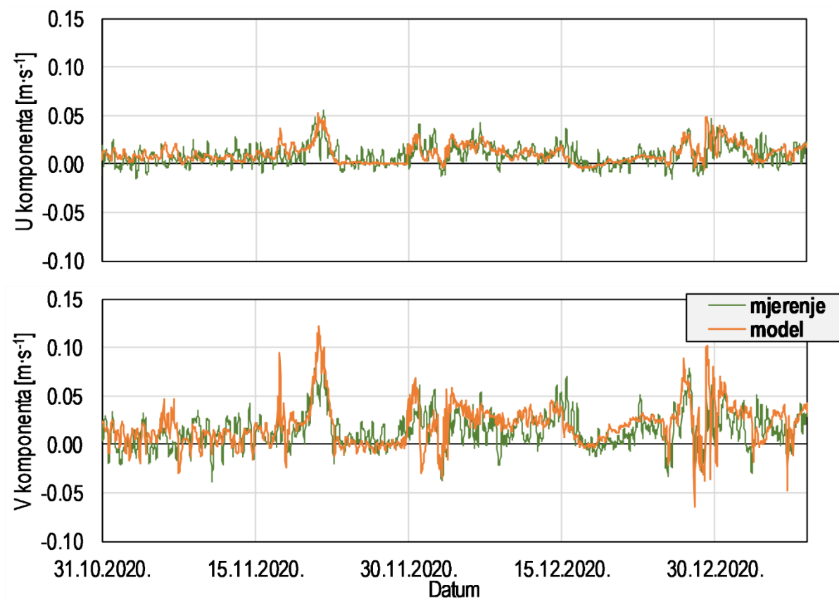
Slika 0-24 Usporedba U (gore) i V (dolje) komponenti brzine strujanja na dubini od -9 [m] za ZIMSKO razdoblje na poziciji ADCP-PL1
