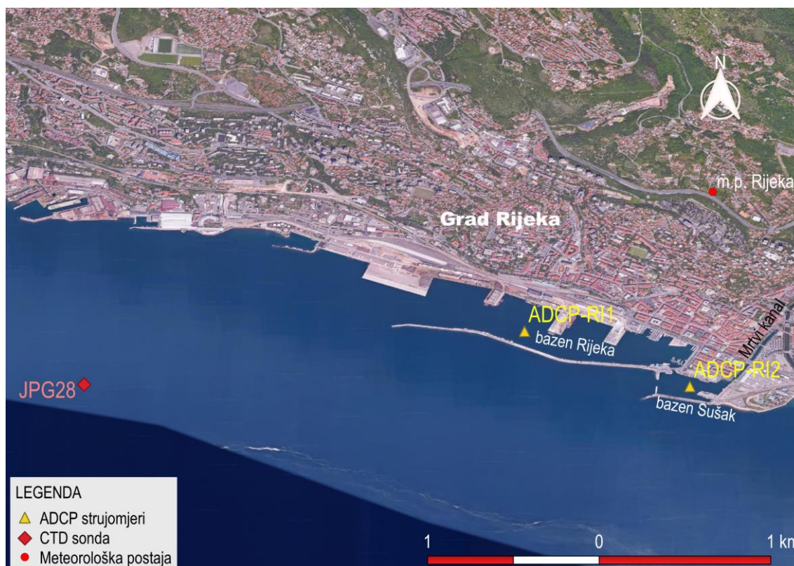
Slika 4-3 Pozicije uzorkovanja vertikalnih profila temperature i saliniteta mora (JPG28), mjerenja brzina morskih struja i dinamike morskih razina (ADCP-RI1, ADCP-RI2), DHMZ meteorološke postaje Rijeka (podloga: Google satelit)
