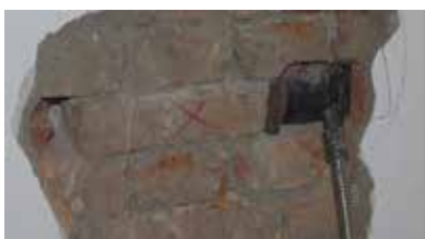
Slika 6. Stambena građevina, Palmotićeva ulica 64a u Zagrebu, ispitivanje posmične čvrstoće ziđa na mjestima PS-1-1 i PS-2-1
