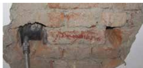
Slika 6. Stambena građevina, Palmotićeva ulica 64a u Zagrebu, ispitivanje posmične čvrstoće ziđa na mjestima PS-1-1 i PS-2-1
