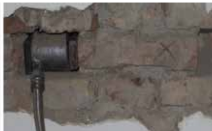
Slika 4. Stambeno-poslovna građevina, Ulica Ivana Dežmana 9 u Zagrebu, ispitivanje posmične čvrstoće ziđa na mjestima Z4 i Z6
