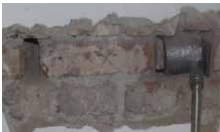
Slika 4. Stambeno-poslovna građevina, Ulica Ivana Dežmana 9 u Zagrebu, ispitivanje posmične čvrstoće ziđa na mjestima Z4 i Z6
