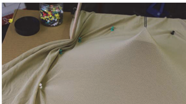
Slika 14. Izrada fizičkih modela vlačnih konstrukcija: podizanje visokih ležajnih točaka
