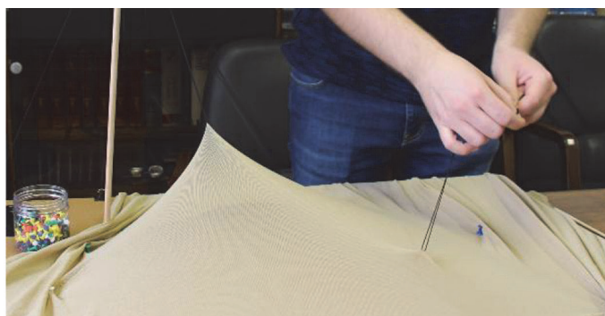
Slika 13. Izrada fizičkih modela vlačnih konstrukcija: označavanje položaja ležajnih točaka i početni položaj tkanine
