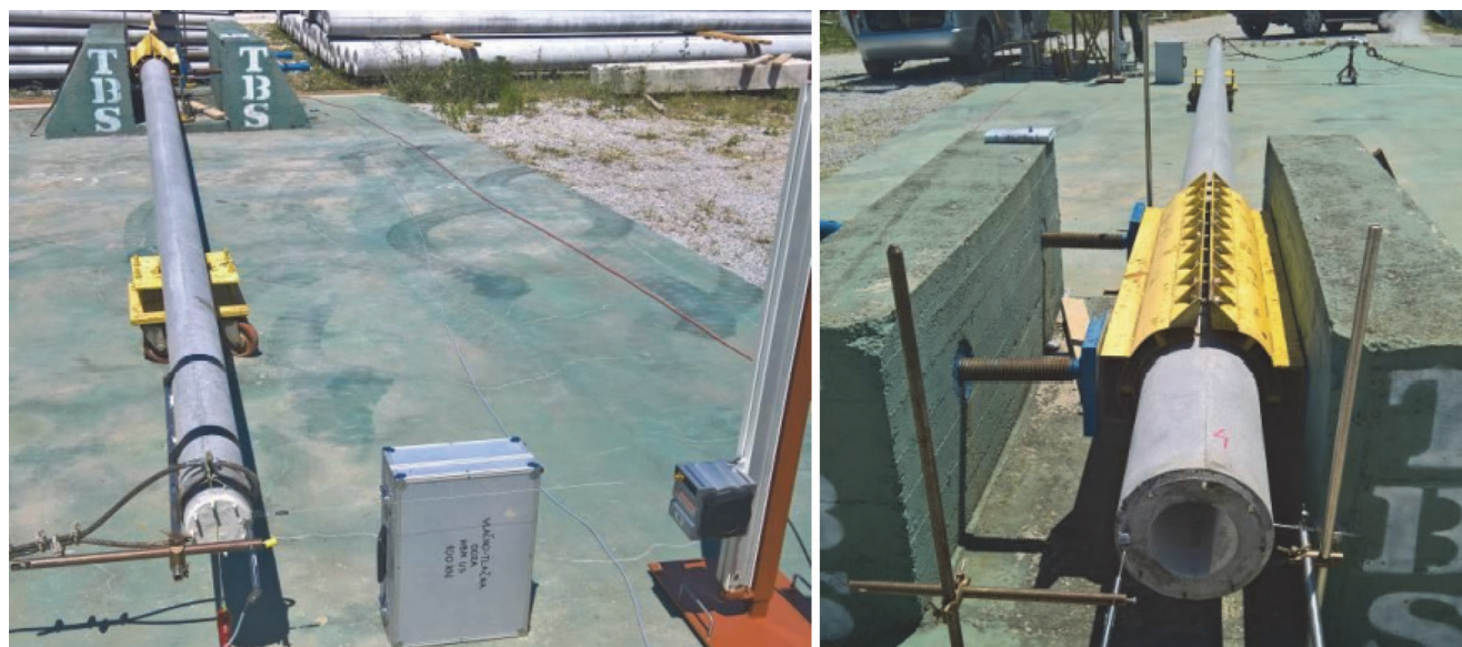
Slika 8. Testni poligon tvornice T.B.S. sa stupom pripremljenim za ispitivanje i mjernom opremom
