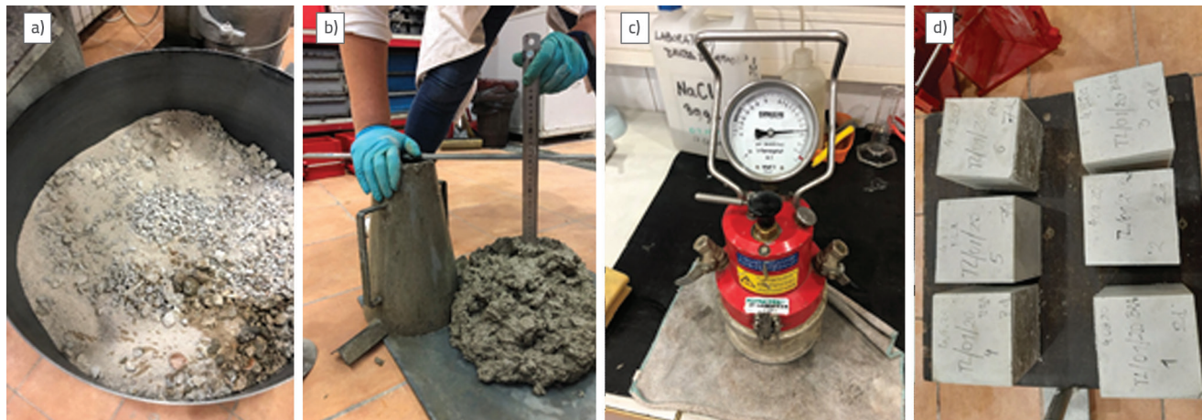
Slika 6. Priprema betona s recikliranim agregatom u laboratoriju: a) agregat, b) ispitivanje konzistencije slijeganjem, c) ispitivanje udjela pora, d) uzorci za ispitivanje tlačne čvrstoće
