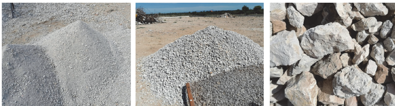
Slika 4. Separirani reciklirani agregat na privremenom deponiju
