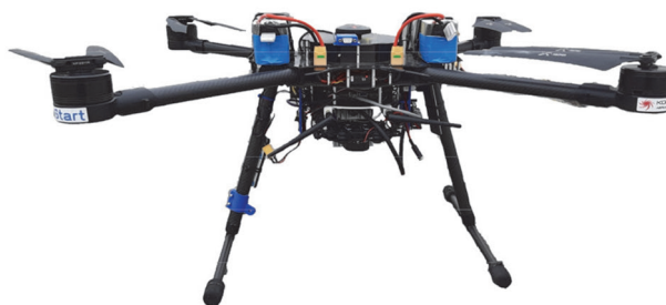
Slika 8. Multirotorska bespilotna letjelica s karbonskim kućištem i četiri pogonska motora opremljena sustavom senzora za vizualni pregled mosta
