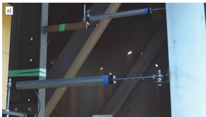
Slika 2. Uređaji za provođenje statičkog probnog ispitivanja konstrukcije: a) LVDT [3] b) Laser [4]
