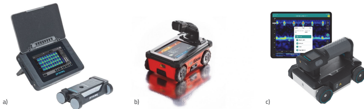
Slika 1. Uređaji za ispitivanje: a) profometer 650 AI, b) georadar StructureScan Mini XT, c) georadar GP 8000
