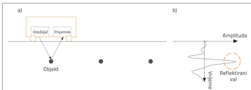
Slika 3. a) Sustav georadara, b) A-sken
