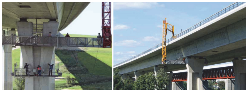
Slika 12. Primjeri specijalnih dizalica za pregled mostova [29]
