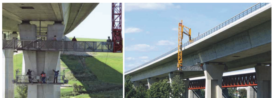
Slika 12. Primjeri specijalnih dizalica za pregled mostova [29]
