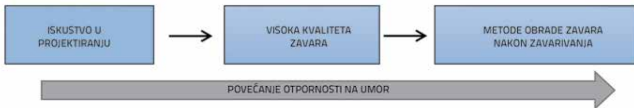
Slika 2. Način postizanja visoke otpornosti na umor
