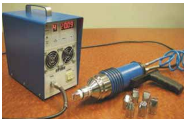
Slika 4. Primjer HFMI uređaja i različitih dostupnih glava [12]
