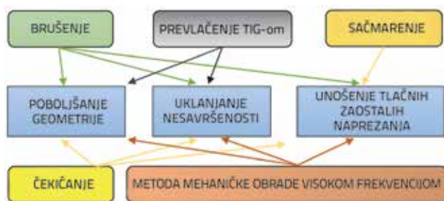
Slika 3. Mogućnosti poboljšanja zavara s obzirom na metode poboljšanja
