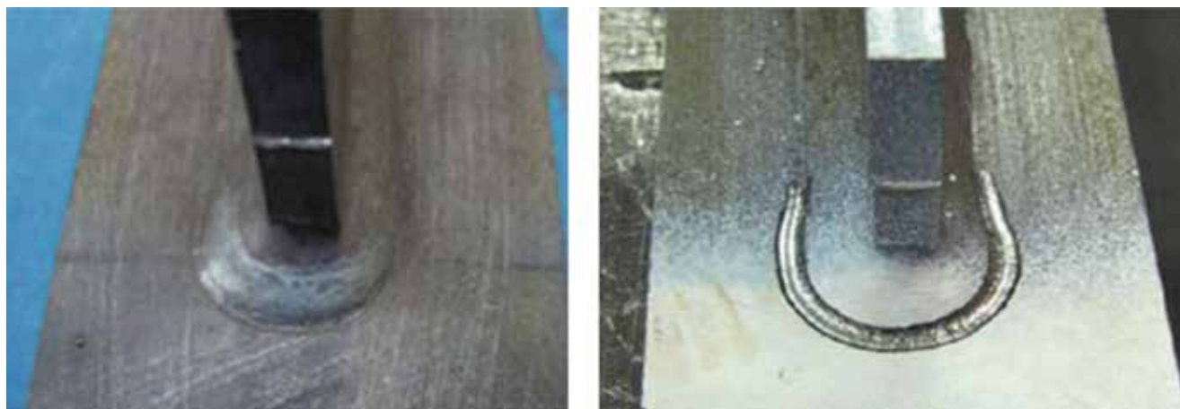
Slika 5. Neobrađeni (lijevo) i kutni zavar nakon HFMI obrade (desno) [12]
