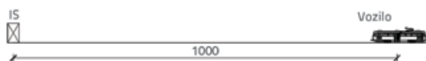
Slika 14. Shema promatranog segmenta kolosijeka, vozilo na udaljenosti 1000 m od ispravljačke stanice (IS)
