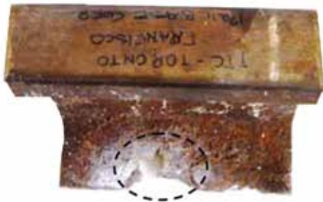
Slika 9. Ispitivani uzorak korodirane tračnice, gubitak materijala s bočne i gornje strane nožice tračnice; zaokružena mjesta predstavljaju mjesta koncentracije najvećih normalnih naprezanja [31]
