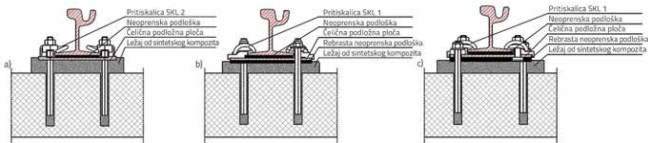
Slika 2. Poprečni presjek sustava pričvršćenja u gradu Zagrebu: a) ZG 3/2; b) PPE; c) DEPP [8]
