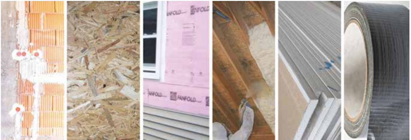
Slika 10. Proizvodi kojima NIJE moguće ostvariti zrakonepropusnost vanjske ovojnice zgrade
