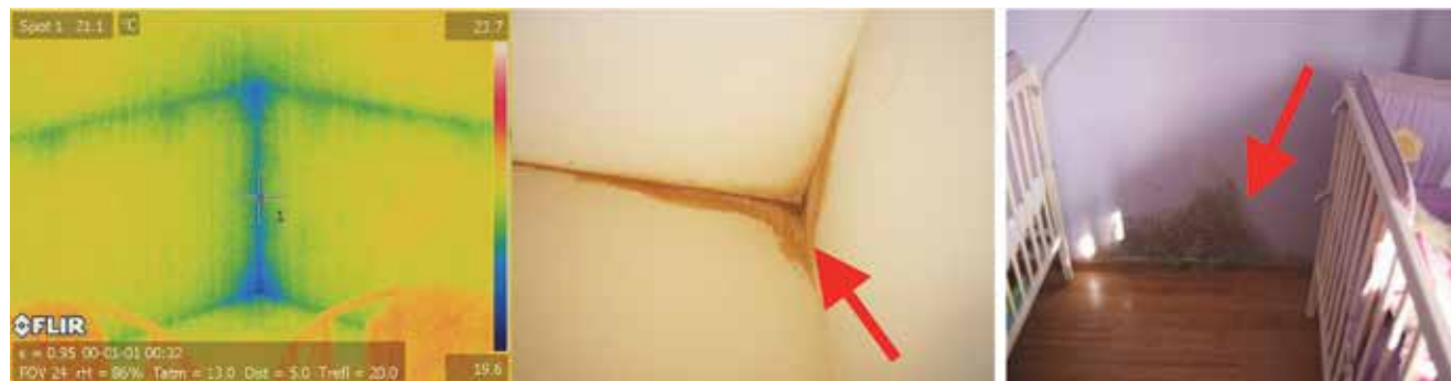
Slika 13. Termogram toplinskog mosta u izvedenoj NZEB obiteljskoj kući u Zagrebu (lijevo), prikaz posljedice toplinskih mostova (sredina i desno)
