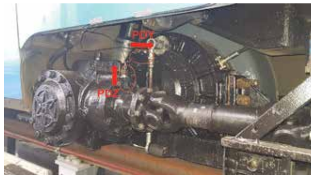
Slika 21. Pozicija akcelometara na voznom postolju prilikom mjerenja
