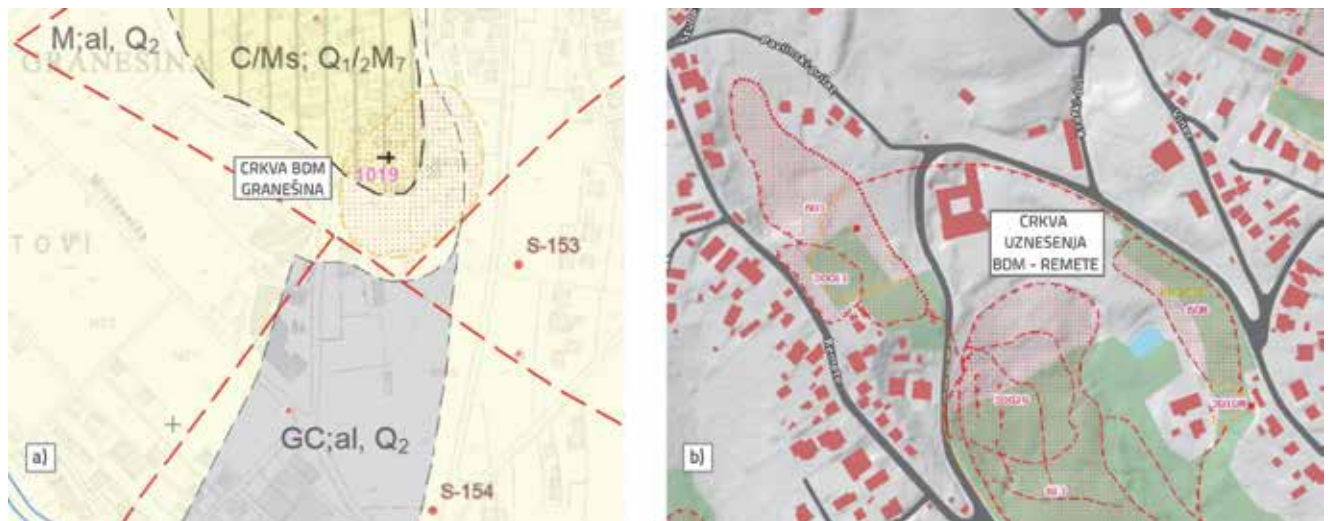
Slika 11. Lokacije oštećenih crkvi: a) crkva u Granešini na detaljnoj inženjerskogeološkoj podlozi preuzetoj iz [42]; b) prikaz crkve u Remetama i nestabilnih padina u okruženju na podlozi preuzetoj iz [47]
