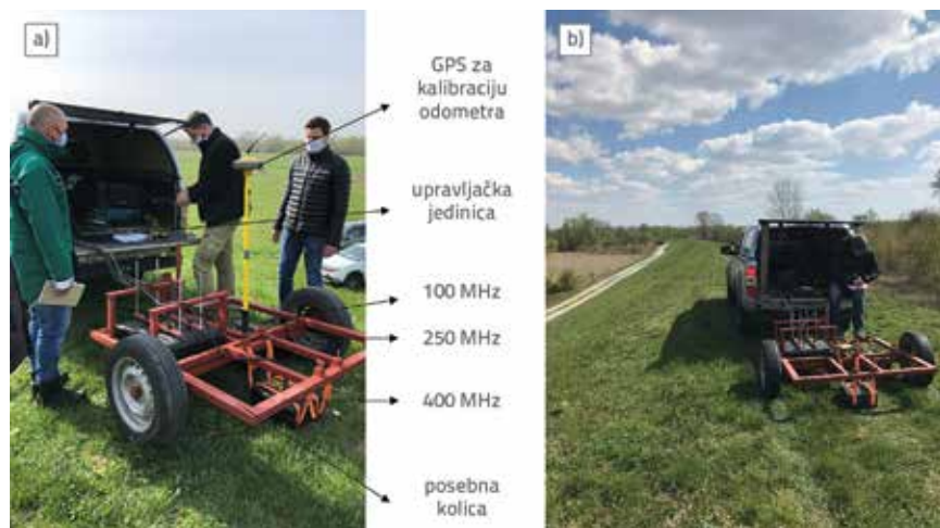
Slika 14. Ispitivanje oštećenja savskih i uspornih nasipa u gradu Zagrebu i okolici nakon potresa u ožujku 2020.: a) prikaz opreme za prikupljanje podataka, b) provedba prikupljanja podataka
