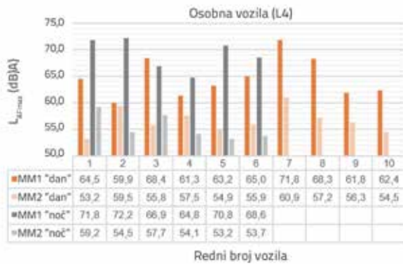
Slika 15. Rezultati mjerenja buke pojedinačnih vozila na lokaciji L4
