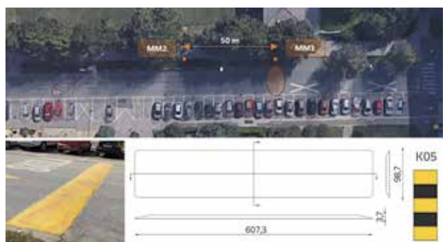
Slika 11. Promatrani dio u Ulici Pile IV. i uska poprečna betonska umjetna izbočina [41]
