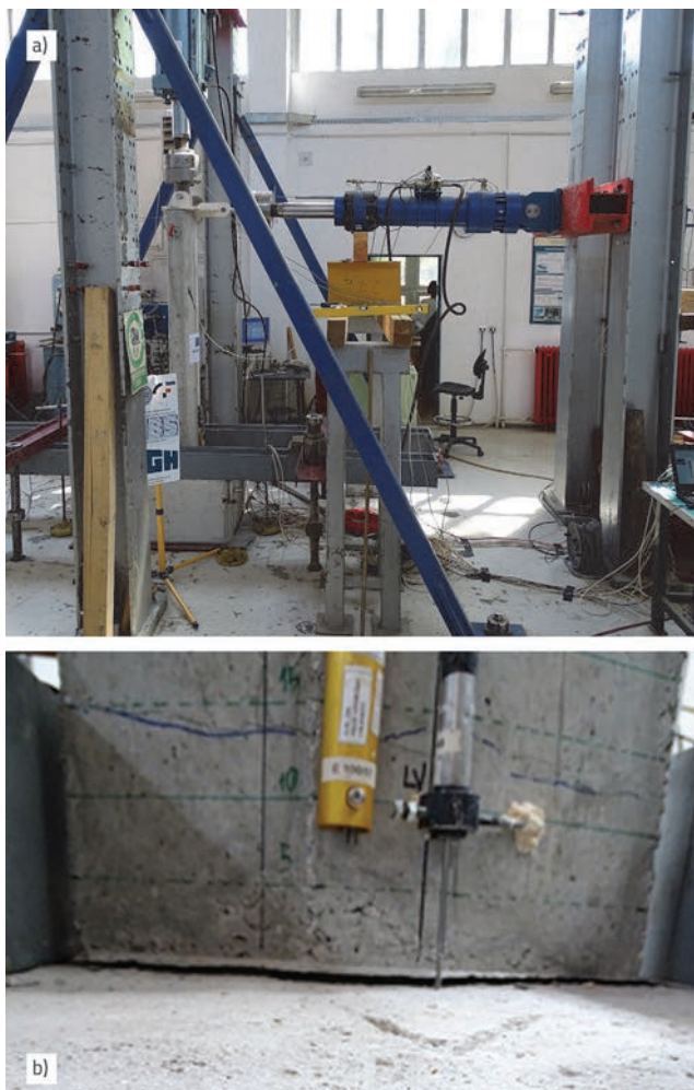
Slika 6. a) Prikaz postavljenog ispitivanja stupa u laboratoriju; b) Otvaranje pukotine na mjestu krajnjeg presjeka
