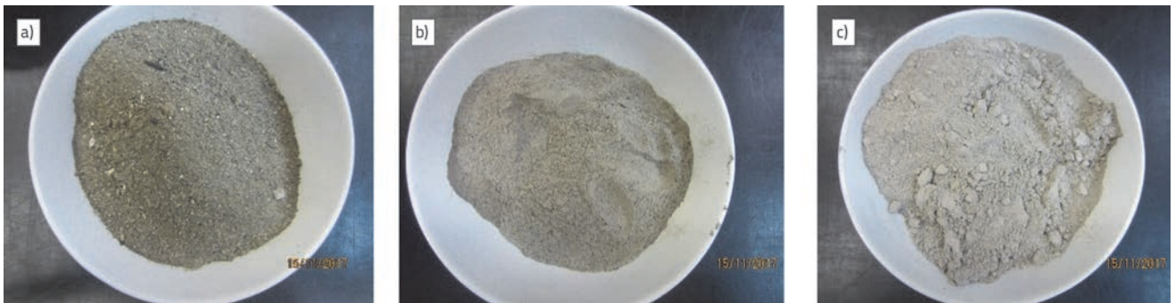
Slika 3. Uzorci pepela drvene biomase: a) pepeo s dna peći; b) leteći pepeo krupnije frakcije; c) finiji leteći pepeo
