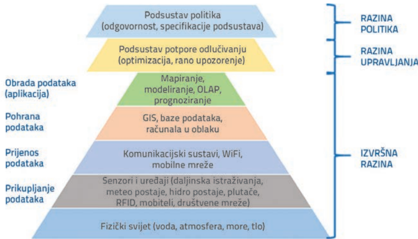
Slika 2. Funkcionalne komponente integriranog informacijskog sustava gospodarenja vodama
