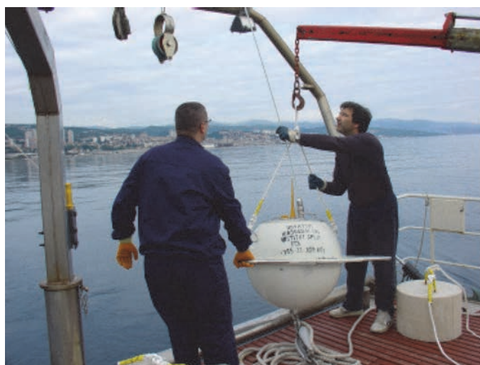
Slika 7. Mjerna plutača Waverider DATAWELL DWR MKIII ispred grada Rijeke u periodu 2009.-2010., postavljanje plutače i izmjereni usmjereni spektar valne energije (u realnom vremenu)
