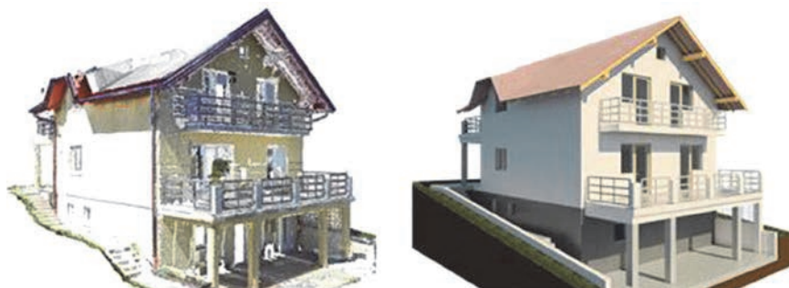
Slika 3. Usporedba oblaka točaka skeniranog objekta i BIM modela [32]
