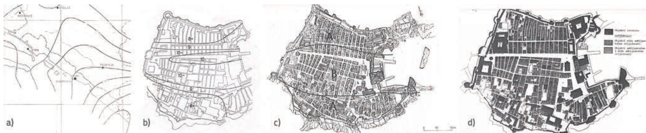
Slika 9. Monografija [77]: a) Karta seizmičkog hazarda, b) Mikrozoniranje stare jezgre, c) Geotehničko zoniranje, d) Kategorizacija oštećenja zgrada
