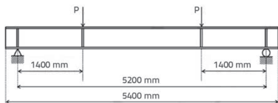
Slika 3. Statički sustav ispitivanog nosača, preuzeto iz [1]
