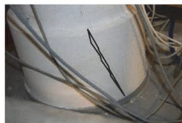
Slika 6. Dijagram ispitivanja uzorka K3 – relativne deformacije (naprezanja) u vremenu s prikazom tijeka unosa opterećenja za mjerno mjesto vrh stupa (VS) s fotografijama otvaranja pukotina u VS i DS
