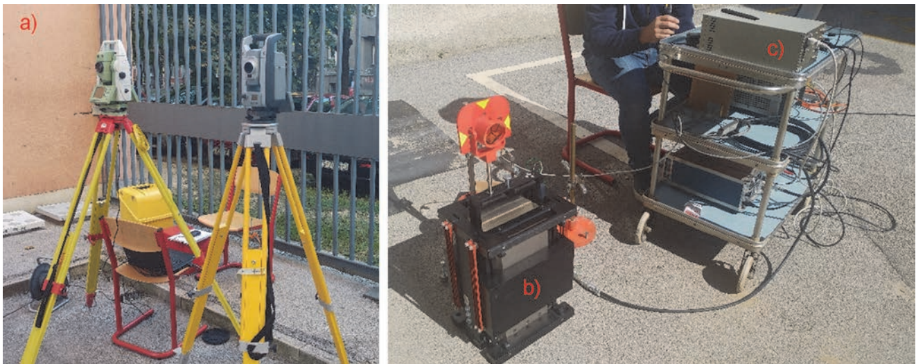
Slika 5. a) RTS uređaji; b) elektrodinamički pobuđivač s reflektorom; c) generator frekvencija s pojačalom
