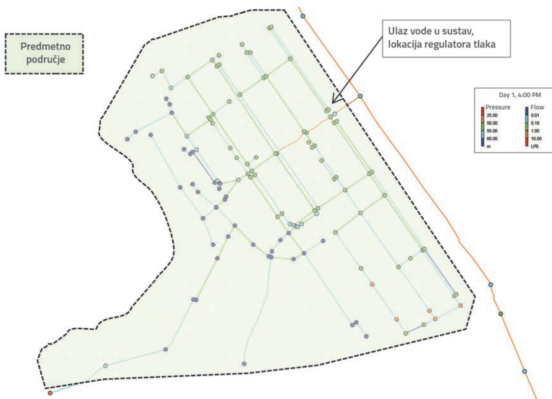
Slika 11. Shematski prikaz analiziranog vodoopskrbnog sustava (izvod iz kreiranog Epanet modela)
