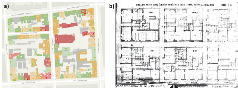
Slika 1. Podaci potrebni za procjenu oštećljivosti: a) Rezultati pregleda građevina nakon potresa [7], b) Projektna dokumentacija [8]
