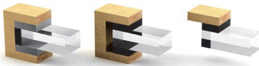
Slika 2. Lijepljeni spojevi drvo-staklo, Niedermaier [16]
