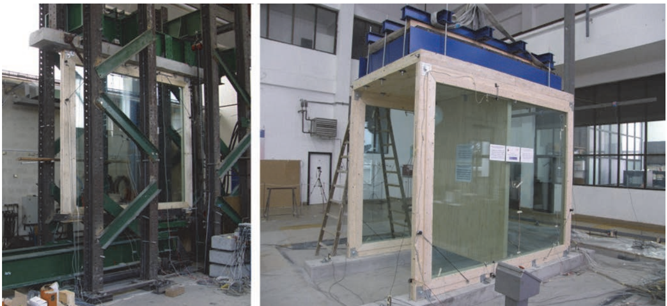
Slika 11. Kompozitni sustavi predstavljeni u radu Rajčić i Žarnić [7, 32-36]; kvazistatička ispitivanja i ispitivanja na potresnom stolu
