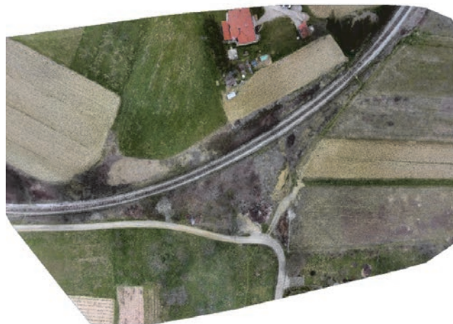
Slika 12. Ortofoto karta iz fotografija snimljenih bespilotnom letjelicom
