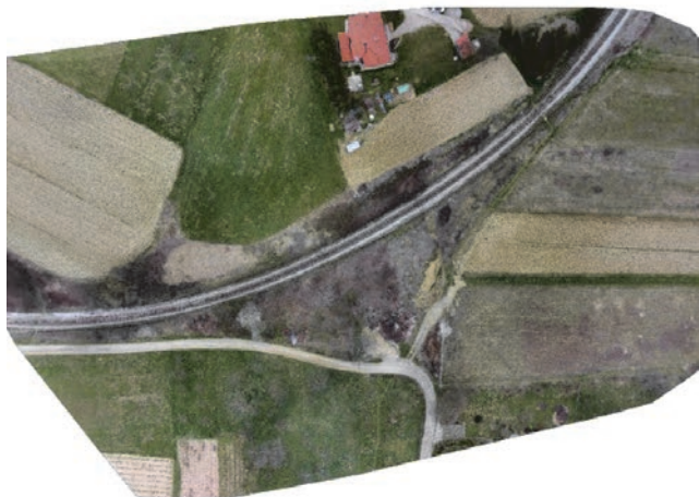
Slika 12. Ortofoto karta iz fotografija snimljenih bespilotnom letjelicom
