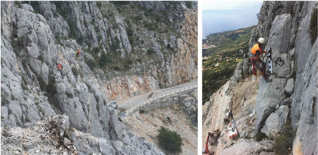
Slika 2. Geološko-alpinističko kartiranje potencijalno nestabilnih blokova na cesti D512 Makarska - Ravča
