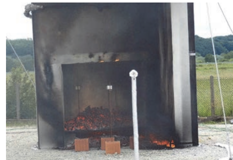
Slika 14. 54 minute nakon početka – tinjanje uzorka EM_2
