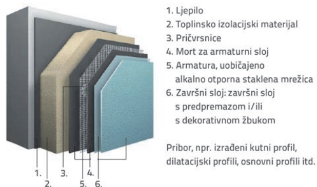
Slika 1. Komponente ETICS sustava [3, 4]
