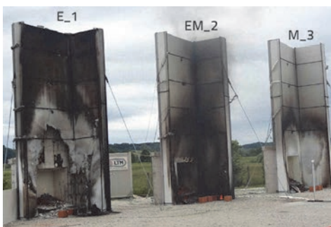
Slika 15. 57 minuta nakon početka – izvor topline je izgorio
