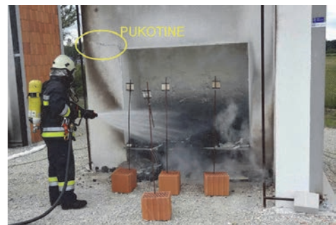
Slika 16. 64 minute nakon početka – vatrogasci polijevaju M_3 zbog sigurnosnih razloga
