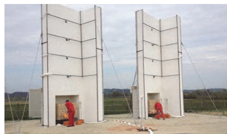
Slika 9. Paljenje konstrukcije od drvenih letvica – početak požara
