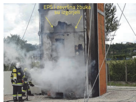
Slika 18. 67 minuta od početka – vatrogasci polijevaju E_1 zbog sigurnosnih razloga
