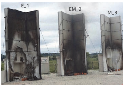
Slika 15. 57 minuta nakon početka – izvor topline je izgorio
