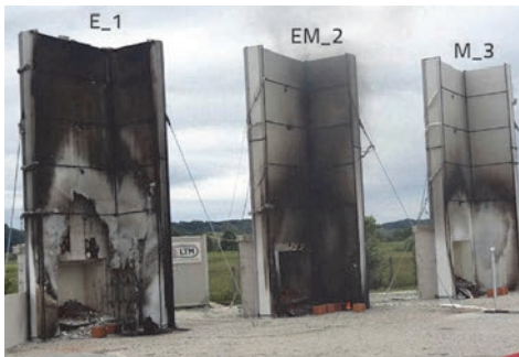
Slika 15. 57 minuta nakon početka – izvor topline je izgorio
