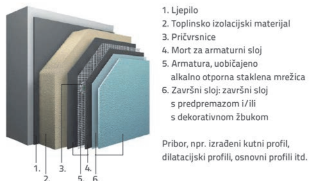
Slika 1. Komponente ETICS sustava [3, 4]
