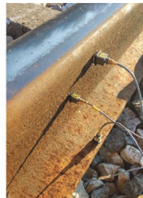
Slika 12. Pozicije akcelerometara na poprečnom presjeku tračnice za mjerenje stupnja prigušenja vibracija, te smjer unosa sile u horizontalnom i vertikalnom smjeru
