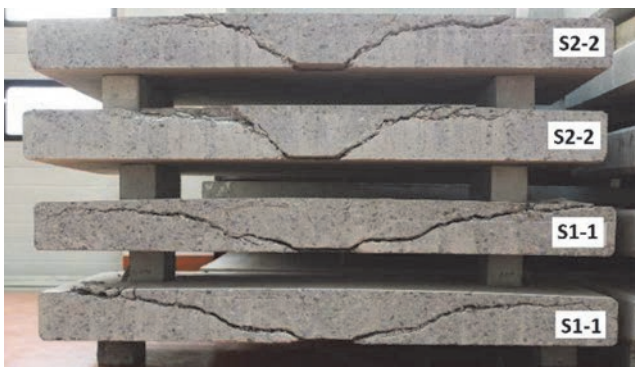
Slika 18. Prerezane ploče S1-1 i S2-2 nakon ispitivanja
